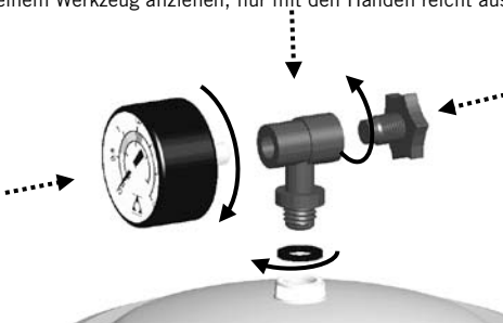
Montage des Manometers (Bei Seiten-Ventil)
